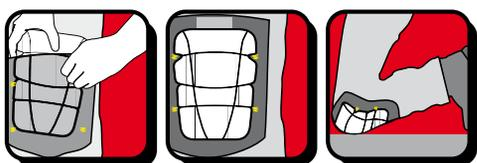
Le imbottiture SAFEKNEE vanno collocate all'altezza del ginocchio facendo coincidere il sistema di travettatura della tasca con il punto di rientro che permette il posizionamento più comodo.
