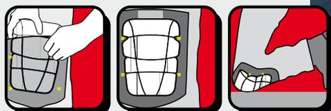
Le imbottiture SAFEKNEE vanno collocate all'altezza del ginocchio facendo coincidere il sistema di travettatura della tasca con il punto di rientro che permette il posizionamento più comodo.
