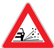
Mod. 29 MATERIALE INSTABILE SULLA STRADA
